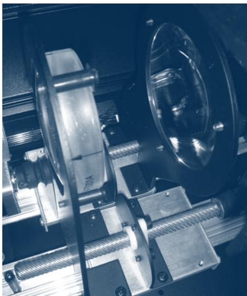
Fig. nº 4. 20 - Sistema zoom motorizado de um Cyberlight da HIGHEND
