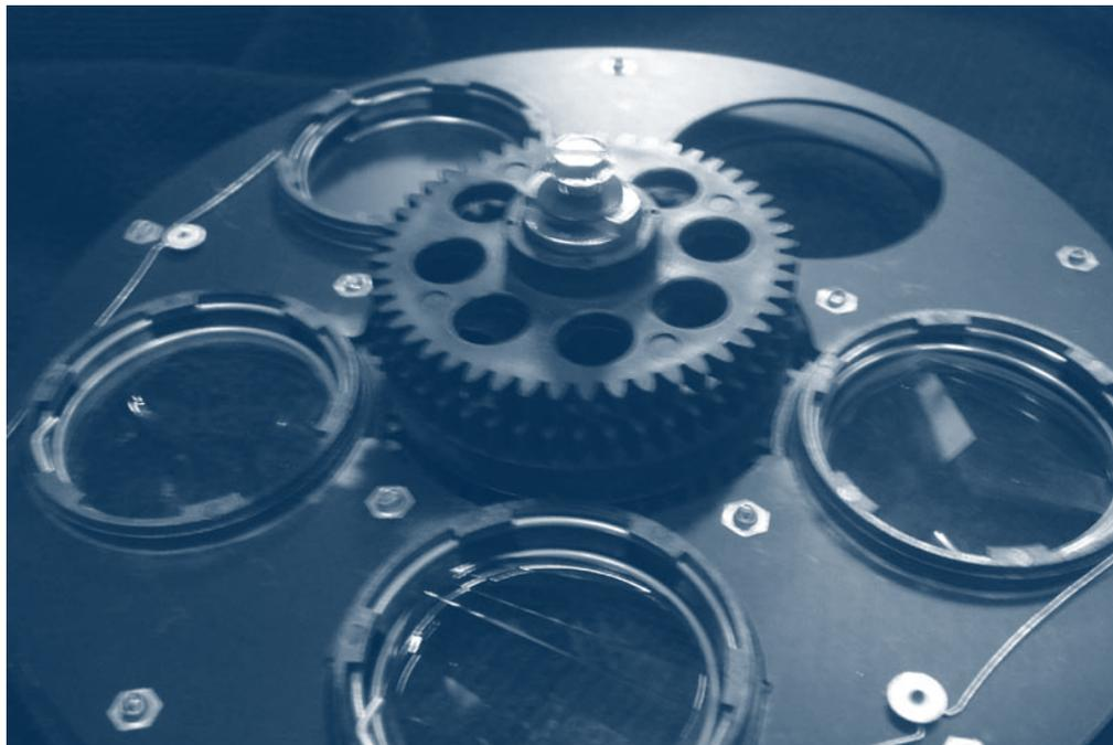
Fig. nº 4. 18 - Sistema motorizado de “bandeiras” para difusão da luz.
