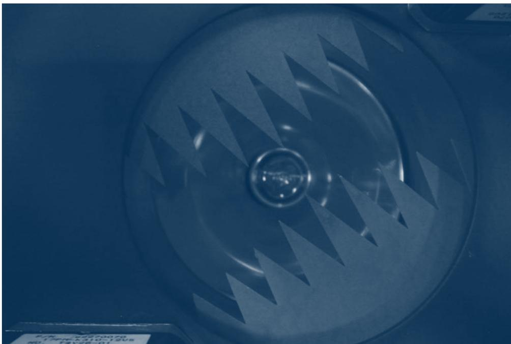
Fig. nº 4. 11 - Mecanismo em forma de diafragma para regular a intensidade de um Studio Color da HIGHEND
