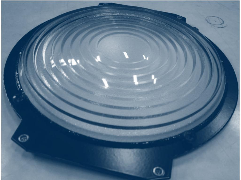
O diagrama dos raios está representado no esquema 8: quando raios paralelos ao eixo óptico passam por uma lente plano-convexa ou *Fresnel*, estes convergem para um ponto (ponto focal), por isso, da mesma forma, se colocarmos uma fonte de luz no ponto focal de uma destas lentes, os raios sairão da lente paralelos ao eixo óptico (ver Esquema nº 9).
