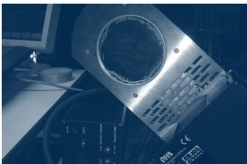
Fig. nº 3. 39 - Rotor de gobos e caixa de alimentação e interface DMX
