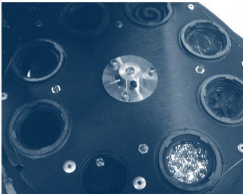
Imagem 4. B - Roda de cores com vidros dicróicos de um Spot 250AT da ROBE(ver anexo)
