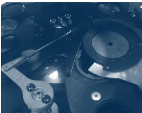
Fig. nº 4. 22 - Módulo de facas motorizado de um S4 Revolution da ETC.
