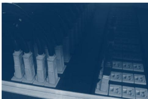
Fig. nº 3. 44 - Hard-Patch por Patchbay. Correspondência através de chicotes unipolares. Existem vários tipos de fichas utilizadas para fazer este tipo de patch
