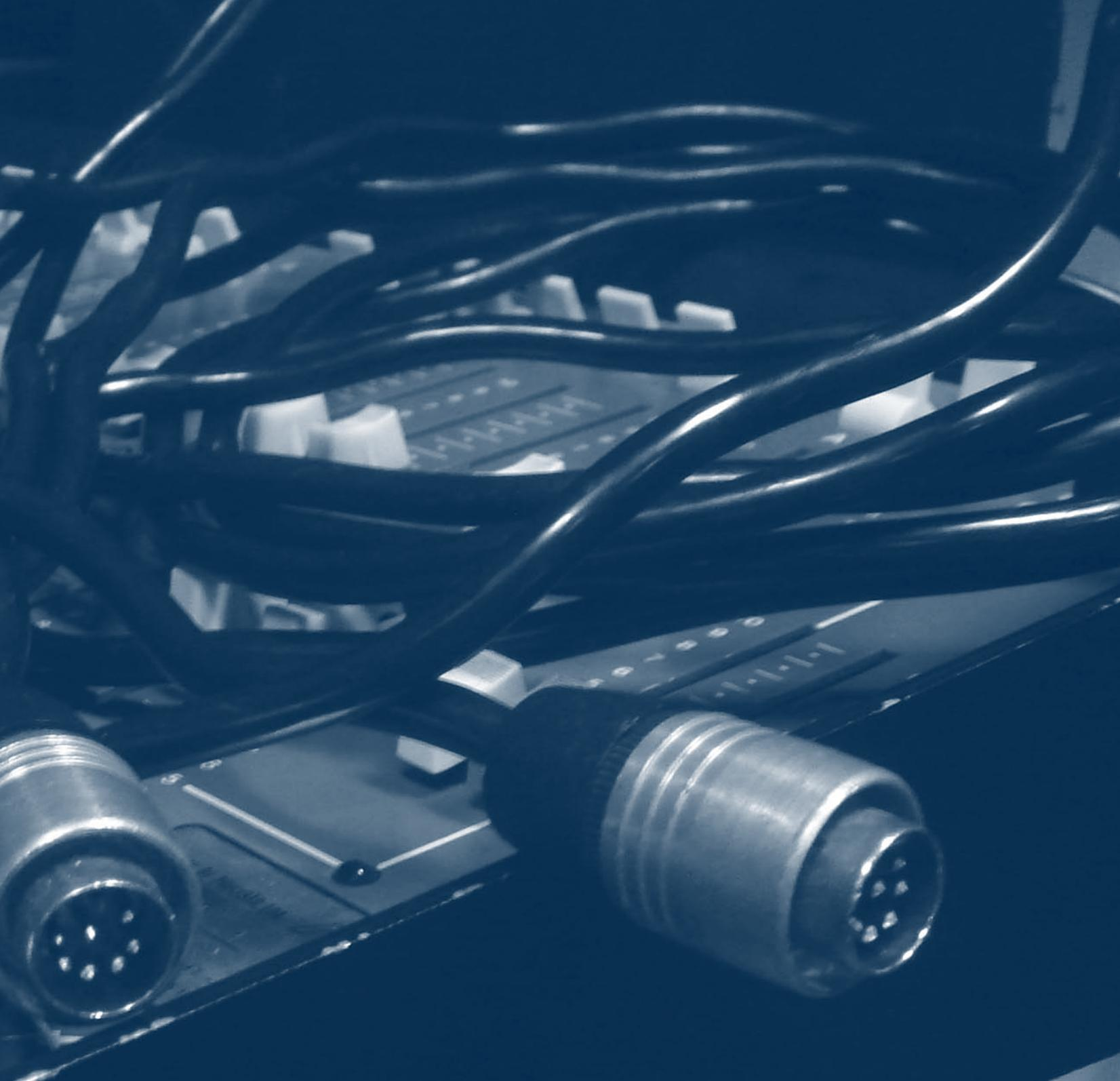
Fig. nº 3. 55 - Mesa manual Tempus de 18 canais da STRANDLIGHTING com controlo analógico 0-10v. Cada uma das fichas, observadas na figura, controla 6 canais de dimmer. O tipo de ficha era uso exclusivo da marca, podendo apenas, controlar dimmers da mesma marca como a ACT6 da Fig. nº 3. 46
