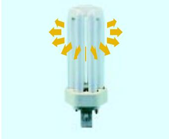
Fluxo Luminoso é a radiação total da fonte luminosa, entre os limites de comprimento de onda mencionados (380 e 780nm). (Figura 4)
