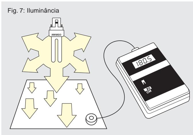
A luz que uma lâmpada irradia, relacionada à superfície a qual incide, define uma nova grandeza luminotécnica, denominada de Iluminamento ou Iluminância. (Figura 7)
