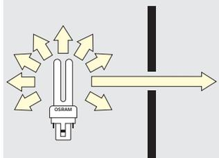
Se a fonte luminosa irradiasse a luz uniformemente em todas as direções, o Fluxo Luminoso se distribuiria na forma de uma esfera. Tal fato, porém, é quase impossível de acontecer, razão pela qual é necessário medir o valor
