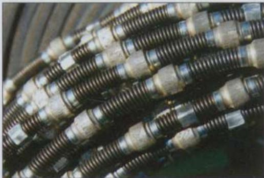
Fig. 15 - Fio diamantado utilizado actualmente nas máquinas de corte, os pequenos grãos que se observam nas pérolas metálicas correspondem a pequenos diamantes que permitem o corte rápido e preciso das massas de mármore.
