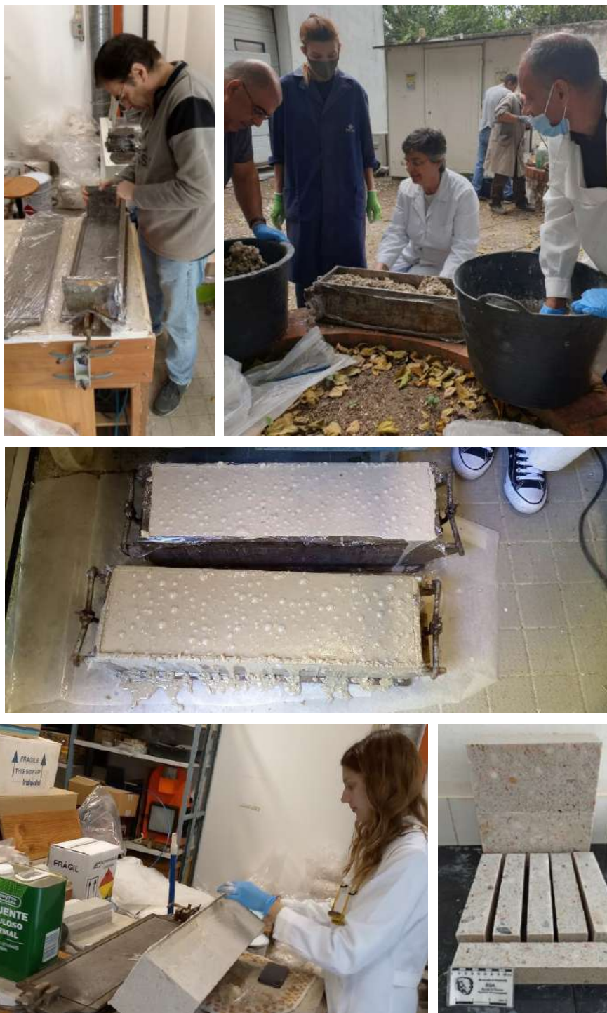
Figura 11 – Preparação dos moldes, enchimento dos mesmos, vibração, desmoldagem e provetes longitudinais após corte para ensaios de resistência mecânica à flexão.
