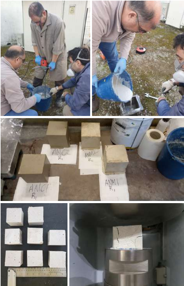
Figura 9 – Mistura mecânica do ligante, despejo em moldes, cubos desmoldados, provetes elementares de 15 cm de aresta e provete com 5 cm de aresta ensaiado na prensa para obtenção da resistência mecânica à compressão.
