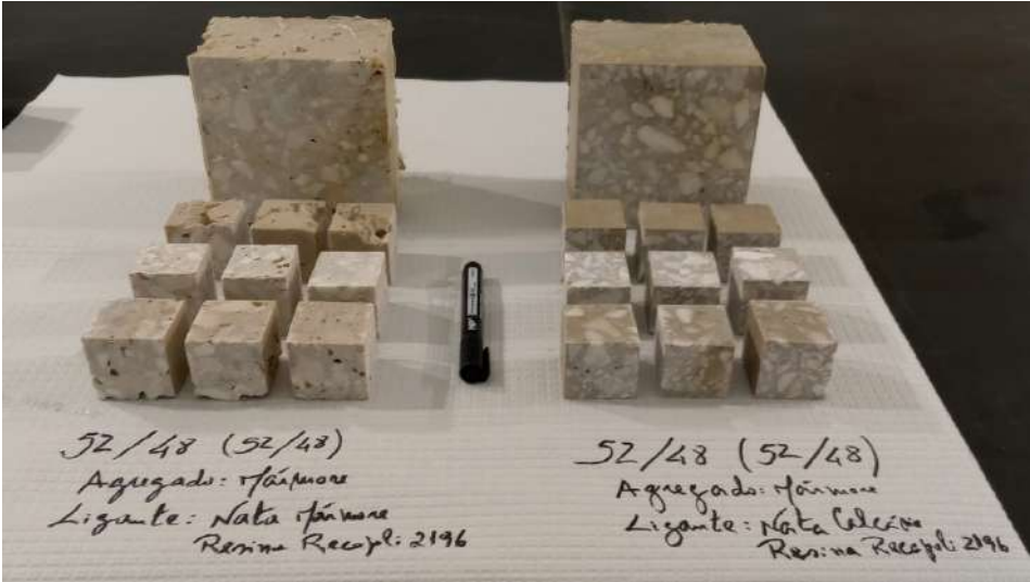
Figura 10 – Provetes cúbicos de 15 cm de aresta e 5 cm de aresta, estes para o ensaio de resistência mecânica à compressão.
