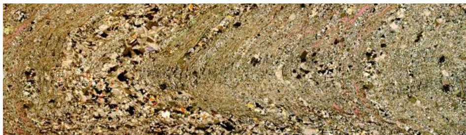
Figura 16 – Composição de várias fotografias para nos dar uma ideia mais abrangente da lâmina delgada. O comprimento real da área fotografada é cerca de 1,5 centímetros.
