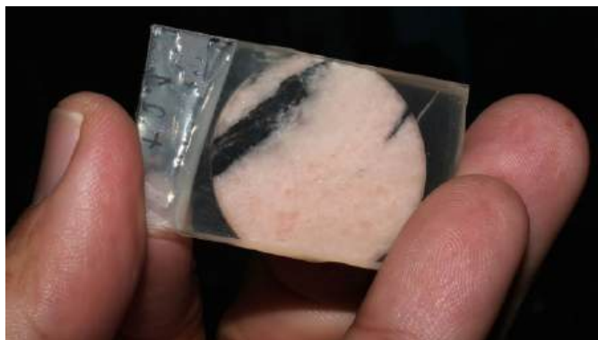
Figura 6 – Talisca do provete número 2 após o corte com a serra de precisão e antes do desgaste na máquina de lâminas delgadas Logitech.
