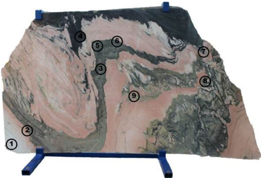
Figura 3 – Chapa de mármore em exibição no Museu do Mármore de Vila Viçosa (Museu Raquel de Castro), com indicação dos locais de amostragem para a elaboração de lâminas delgadas. Por razões estéticas, as amostras foram recolhidas na parte de trás da chapa. Junto dos pontos de amostragem 5 e 6 podem-se observar dobras menores geometricamente semelhantes às definidas pela massa mais escura que contem os pontos 2, 3, 5 e 6.
