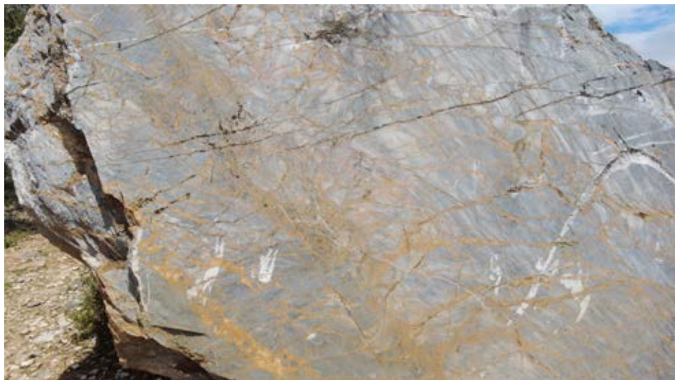
Figura 8 – O mármore representado nesta imagem corresponde a um acaso furtivo e único que ocorre na pedreira do Monte da Marinela, com laboração suspensa, em Estremoz. Efetivamente a libertação quase instantânea das tensões acumuladas na água que preenchia os poros das rochas, levou a uma intensa fragmentação do mármore, posteriormente e porque também havia ferro em disponível no sistema geoquímico, ocorre a recristalização de calcite que incorpora esse ferro na sua rede cristalina originando os veios dourados. Como a rocha apresenta um fundo escuro azulado (típico da variedade Ruivina), após polimento resulta este padrão de “ouro sobre azul” único e com belo efeito estético, tendo sido, por exemplo, utilizado no revestimento do interior da Sé Catedral de Maputo, em 1944, pelo arquiteto Marcial Freitas.
