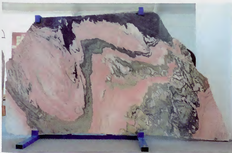
Fig. 7 – Chapa de mármore com intercalações de níveis de rochas metavulcânicas. Devido à elevada percentagem de quartzo (dureza 7 na escala de Mohs) e outros minerais de dureza superior à da calcite (dureza 3 na mesma escala) normalmente as rochas com este aspecto não são processadas. No caso particular, o elevado potencial pedagógico levou a que tivesse sido selecionada, em conjunto com outra que está à sua esquerda, obtida do mesmo bloco e serrada em “livro aberto” para ilustrar no Museu os eventos tectónicos que presidiram à formação da Orogenia Varisca e consequentemente à formação dos próprios mármore. Na parte posterior da chapa foram recolhidas amostras para a elaboração de lâminas delgadas que permitirão o estudo petrográfico e mineralógico das diferentes texturas e variedades de rochas presentes na chapa ao microscópio petrográfico. O corte e polimento em “livro aberto” permitem obter efeitos geométricos muito interessantes e cada vez mais explorados comercialmente.
