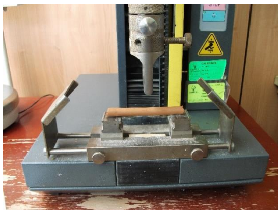
Fig. 4 – Ensaio de resistência mecânica à flexão com recurso a uma prensa (Cencal).
