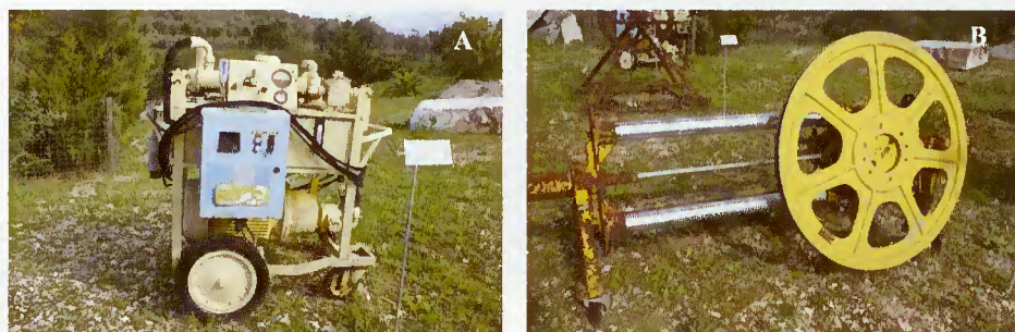
Fig. 17 – Máquina electro-hidráulica, de fio diamantado; A – Centralina; B – Poleia de puxe. Museu do Mármore de Vila Viçosa.
