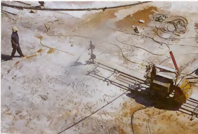
Fig. 18 – Máquina de fio diamantado a executar um golpe vertical em bancada, empresa António Galego & Filhos, Mármore SA.
