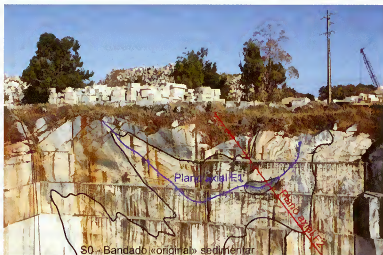
Fig. 11 – Pedreira A. Mocho, Lagoa – Bencatel. A parede SE da pedreira representada na fotografia constitui um afloramento chave para a interpretação da geometria das fases de deformação dúctil que afetaram o Anticlinal de Estremoz e consequentemente todo o Nordeste Alentejano. Facilmente se constata que os planos axiais (plano imaginário que divide simetricamente uma dobra originada por movimentos tectónicos) gerados durante a primeira fase de dobramento varisco (a azul) e que, nesta seção deveriam estar representados por uma linha reta, na verdade também estão curvos, o que corresponde à atuação da segunda fase de dobramento varisco. Os planos axiais desta segunda fase são retilíneos (a vermelho). A deformação incremental, que em último caso, leva a rutura das diferentes camadas de mármore, apresenta ainda comportamentos distintos entre camadas adjacentes, ou porque incluem outros minerais para além da calcite na sua composição ou porque tem espessuras diferentes ou ambos os casos. Tudo isto contribui ainda mais para que a deformação seja heterogênea, levando a que os flancos das dobras sejam estirados (alongados) e que a espessura das bancadas não seja mantida ao longo das dobras que se formam. Todos estes aspetos e ainda outros no domínio da deformação frágil, com formação de falhas e diaclases, podem ser observados e explicados neste local. Para além da beleza estética, foi acima de tudo o interesse científico e valor didático que permitiu inscrever este geomonumento na lista do Património Geológico Nacional.
