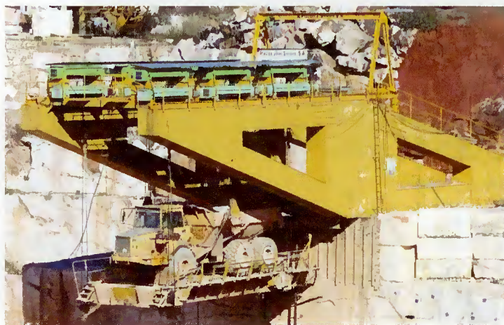
Fig. 14 – Elevador de dumpers da pedreira da empresa Plácido José Simões S.A.
