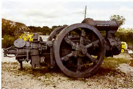
Fig. 11 – Compressor a gasóleo, Ingersoll Rand, fabrico 1917. As rodas não se destinavam à locomção já que se tratam de volantes e assim este equipamento deveria estar assente num fixe, para que estas peças circulares rodassem livremente fazendo movimentar um êmbolo de modo a comprimir o ar que, então seria utilizado como força motriz para operar os equipamentos na pedreira.
