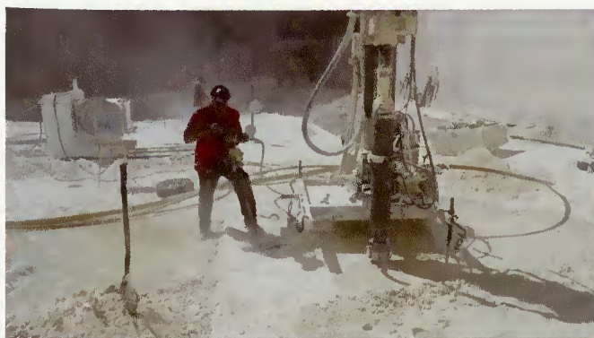
Fig. 15 – Jumbo com bit de 220 mm de diâmetro e trabalhador com martelo pneumático ligeiro, na pedreira da empresa Ezequiel Francisco Alves Lda.
