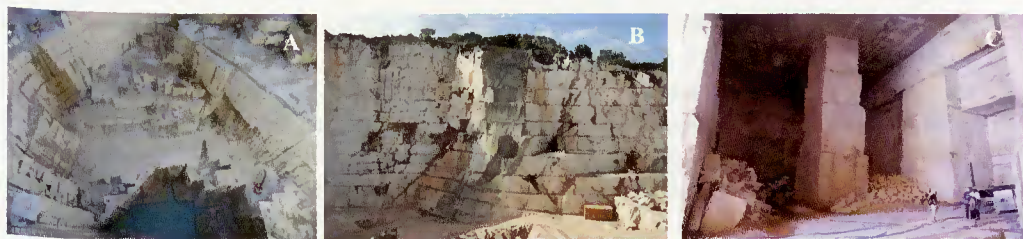
Fig. 21 – A: Pedreira a céu aberto, Pardais, da empresa José Luís Cochicho; B: Pedreira em flanco de encosta, Mouro, empresa Marmoz; C: Pedreira em subterrâneo, Lagoa, Lugramar.
