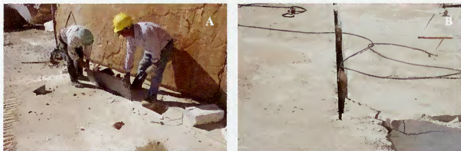
Fig. 19 – A – Introdução de uma almofada de água num golpe (pedreira da Lagoa, da empresa Marmoz, Companhia Industrial de Mármore de Estremoz, Lda.); B – Duas almofadas de água depois de cheias produzindo uma deslocação na talhada.
