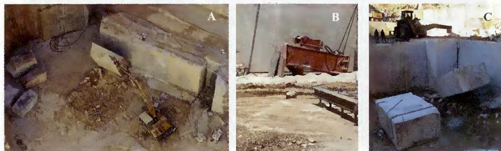
Fig. 20 – A: Derrube com recurso a ripper e retroescavadora (pedreira de Estremoz da empresa Bentel, Sociedade Extractiva de Mármore SA); B: Tomba bancadas hidráulico; C: Derrube com tomba bancadas mecânico acoplado em pá carregadora (pedreira da Vigária da empresa Solubema, Sociedade Luso Belga de Mármore SA).
