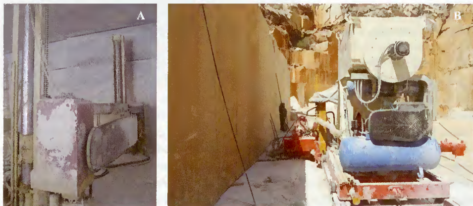
Fig. 16 – A: Roçadora de galeria, de cinta diamantada, empresa Lugramar; B: Roçadora de cadeia de carboneto de tungsténio a executar um golpe de levante, empresa Solubema.
