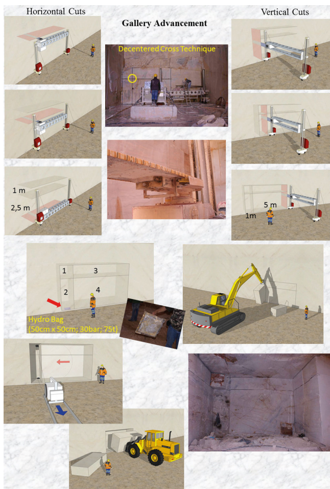
Figura 17 – Avanço em galeria utilizando a técnica da cruz descentrada. Ilustração gráfica original de Emanuel Branco.
