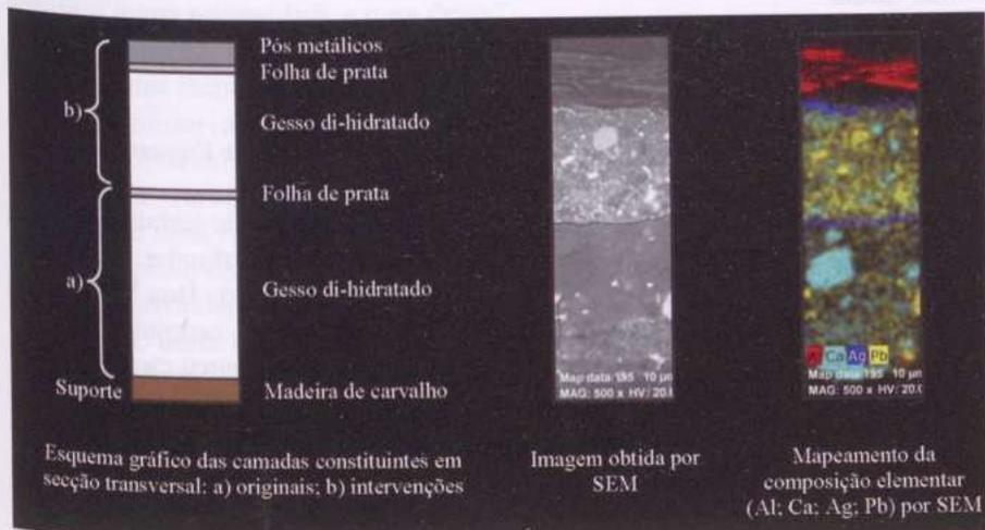
Fig.17 – Representação estratigráfica da policromia prateada da barca (*luas*) e análises por Microscópio Electrónico de Varrimento.
